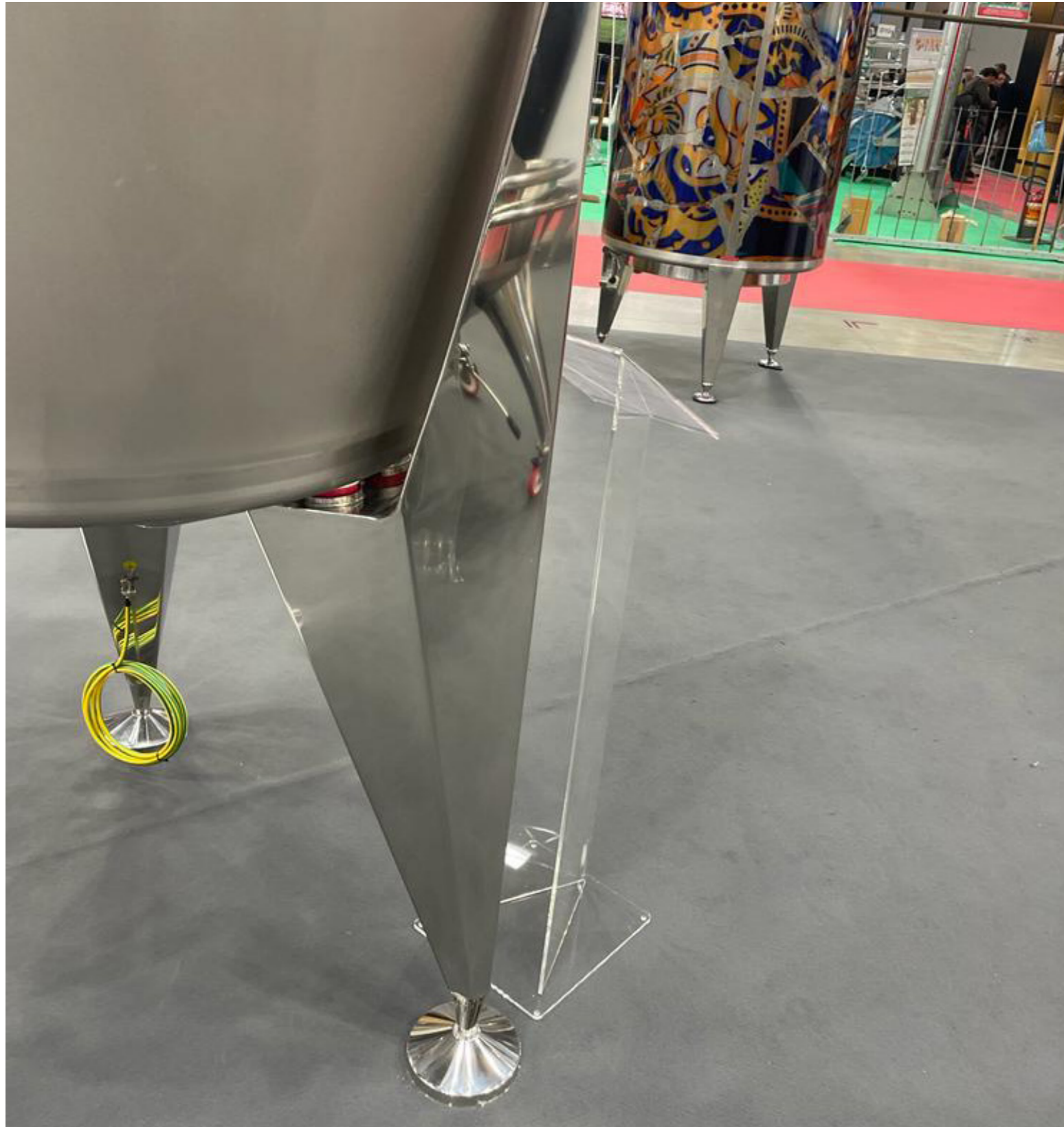
Piedi unici con sistemi Semiblock per creare l'isolamento dal suolo
